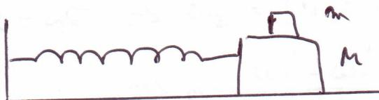
A força proporcionalmente acelerando ao bloco  $m$  é a força de atrito entre o bloco e o disco  $M$ .
